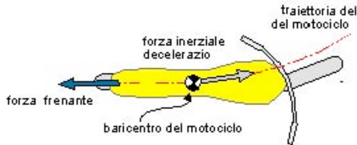
Figura 2 Motociclo in curva con forza frenante solo posteriore
