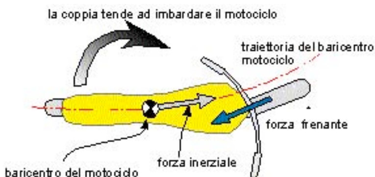
Figura 1. Motociclo in curva con forza frenante solo anteriore
